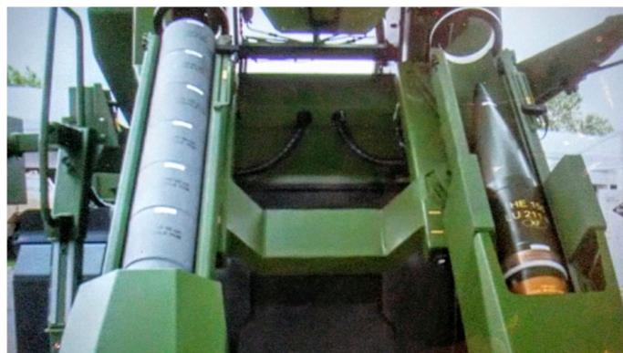
Mécanisme de chargement automatique séparé obus et charges.
